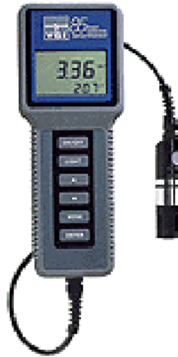
جهاز حديث لقياس الأكسجين الذائب والملوحة ودرجة الحرارة
