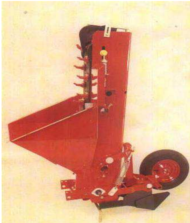
آلة زراعة البطاطس نصف الآلية ذات جهاز التلقيم الرأسي.
