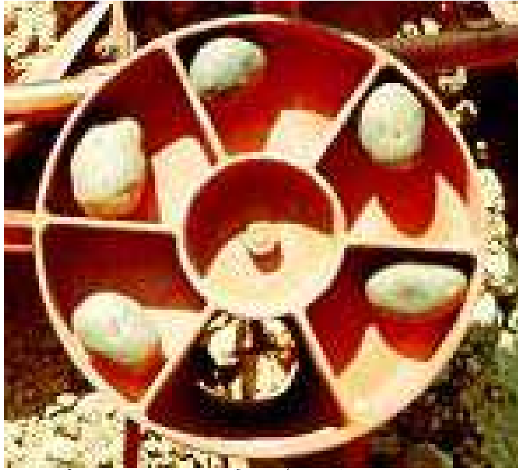
جهاز تلقيم الدرنات ذو القرص الأفقي في آلة زراعة البطاطس نصف الآلية.
