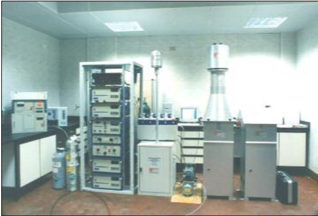
(شكل ٤ : يبين أجهزة الرصد لنوعية الهواء المستخدمة بمحطة الرصد المقترح إنشائها داخل الموانئ)
