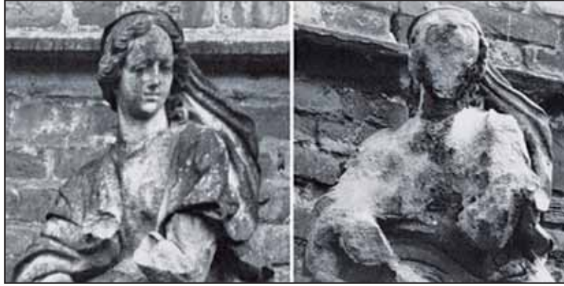
▲ شكل (٤) تآكل التمثال بسبب تأثير الأمطار الحمضية
