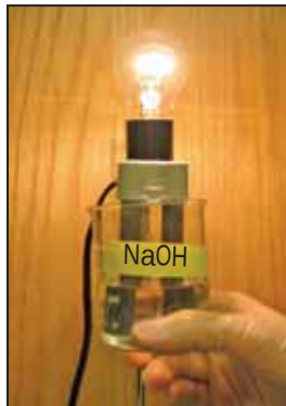
▲ شكل (٢٠) القاعدة القوية توصل التيار الكهربى بدرجة أكبر من القاعدة الضعيفة
