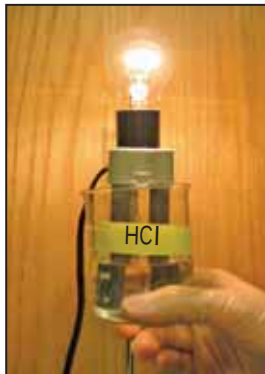
▲ شكل (١٦) الحمض القوي يوصل التيار الكهربى بدرجة أكبر من الحمض الضعيف
