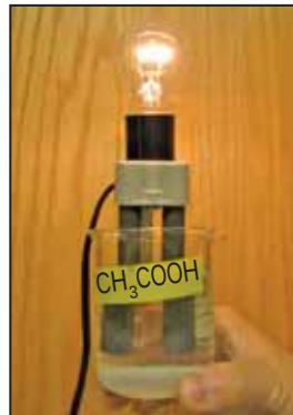
▲ شكل (١٦) الحمض القوي يوصل التيار الكهربى بدرجة أكبر من الحمض الضعيف
