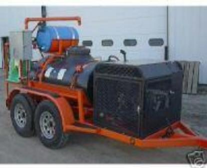
تتوافق هذه الرشاشات بأشكال وأنواع مختلفة، وتشترك في التشغيل الآلي لمضخة سوائل الرش، فبعضها يتم تحريكه على عجل، أو يحمل باليد، غالبيتها محمول على جرار أو على مقطورة خاصة به، وتعتمد على القوة المحركة للجرار نفسه، أو تكون مزودة بآلية خاصة بها يندفع سائل الرش منها تحت ضغط الماء المتتدفق بقوة من أنبوب كبير يعرف بالقاذف اليدوي Hand Gun، و غالبيتها مزود بذراع رش Spray Boom مثبت خلف الجرار أو أمامه، قد يصل طوله إلى ٢٧ متراً، ولا يتجاوز في غالبيتها الأمتار السبعة.
