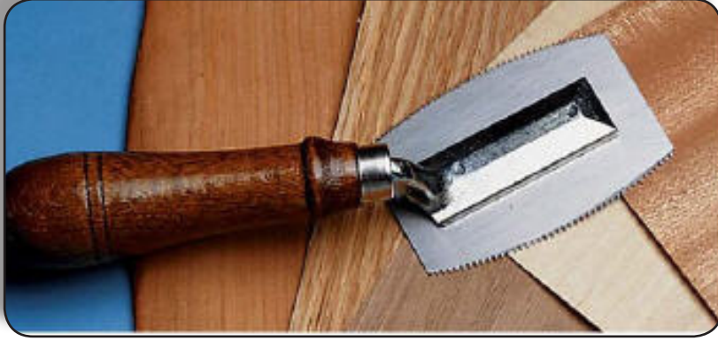
الشكل (٢٥) قطع القشرة باتجاه الألياف
