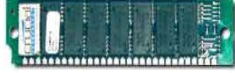
٣٠ دبوساً من نوع SIMM – هذا النوع انقرض من الذاكرة لعدم وجود الأجهزة التي يستخدم عليها
