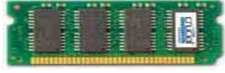
٧٢ دبوساً من نوع SODIMM. تستخدم مع أجهزة الحاسبات المحمولة
