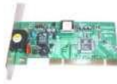
الشكل رقم (٥٢) : المودم الفاكس
