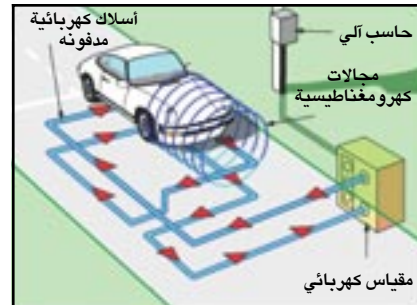
● شكل (٣) يوضح كيفية عمل حساس الإشارة الضوئية .
