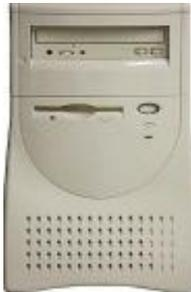
يطلق هذا الاسم على الصندوق الرئيسي الخاص بالحاسوب الشخصي والذي يحتوي على المكونات المختلفة التي يتألف منها جهاز الحاسوب. فتوجد بهذه الوحدة – على سبيل المثال – اللوحة الأم (لوحة النظام) والتي تشتمل على كل الأجزاء الرئيسة، مثل المعالج. ويوجد بها أيضًا مكونات أخرى مثل القرص الصلب ومشغلات الأقراص المرنة والمدمجة وهكذا. وهناك نوعان لهذه الوحدة وهما الوحدة الرأسية – والتي تظهر في الشكل المقابل – والوحدة الأفقية، التي تم تصميمها
