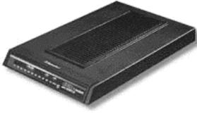
إن المودم عبارة عن جهاز يستخدم في توصيل الحاسوب الذي تعمل عليه بنظام الهاتف. ويقوم المودم بتحويل البيانات إلى صوت يتم إرساله عبر خط الهاتف ويقوم المودم المستقبل بتحويل الصوت إلى بيانات. وإذا رغبت في الاتصال بالإنترنت، ستحتاج إلى مودم.
