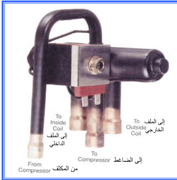
شكل (٣ - ٩ - ب): صمام مغناطيسي رباعي
