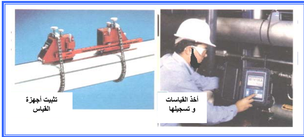
شكل (٢- ١٣): قياس معدل السريان بطريقة الموجات فوق الصوتية [ ٦ ]
