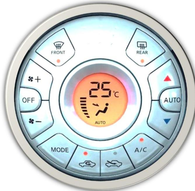
شكل (3 - 3) نظام تحكم الكتروني في درجة الحرارة ومعدل دفع الهواء داخل المقصورة والفتحات المستخدمة
