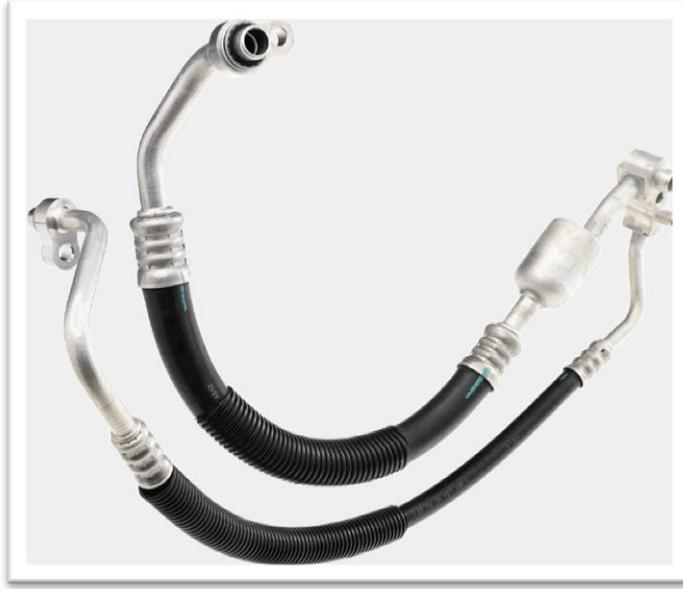
شكل (2 - 17) المواسير الخاصة بدخول الضاغط والخارجة منه ووجود الماسورة المطاطية هي لمنع ايصال الاهتزازات الناجمة من حركة الضاغط عبر سير المحرك نحو الاجزاء الاخرى والاضرار بها
