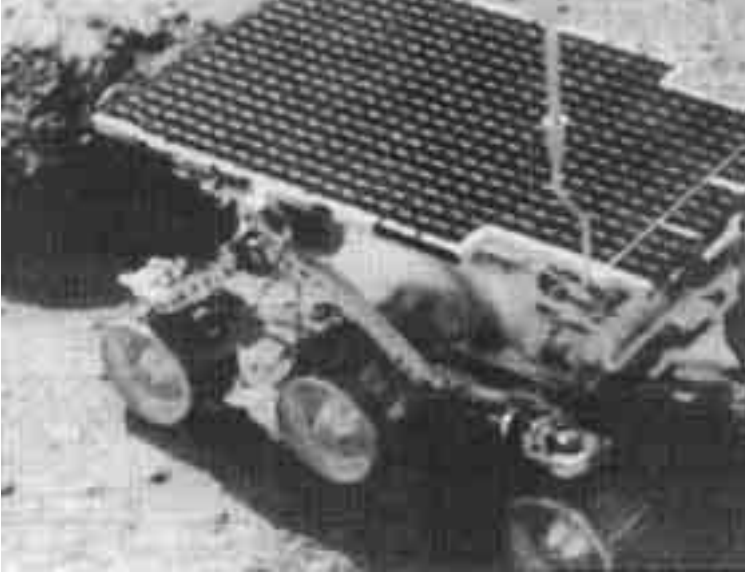
سطح الخربة الجواله وعليه الخلايا الكهروضوئية
