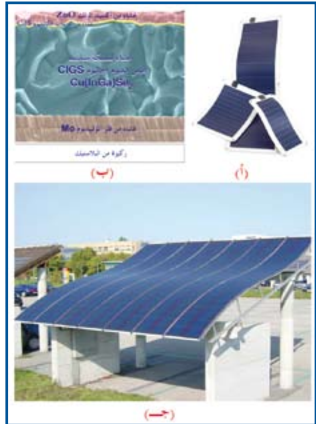
الشكل (3): يمثل الشكل (i) نماذج من خلايا الجيل الثاني الكهروضوئية التي تتمتع بليونة عالية. ويبين الشكل (ب) صورة ملتقطة بواسطة المجهر الماسح الإلكتروني لقطاع رأسي من تلك الخلية يبين تركيب طبقاتها وترتيبها. وتعرض الصورة في (ج) نموذجاً من وحدات تلك الخلية وتم عرضه لبيبين مدى ليونته وسهولة استخدامه.
