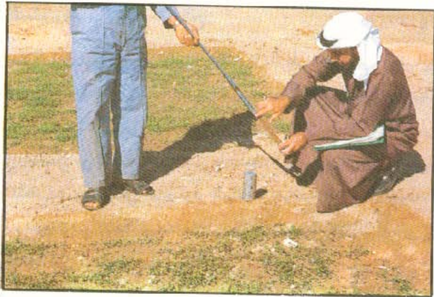
إستخدام الأوجر في أخذ عينات التربة لتقدير نسب الرطوبة .
