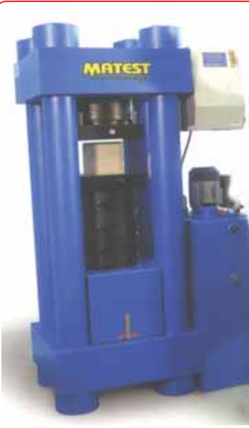
الشكل (١٠) جهاز كسر عينة من الطوب
