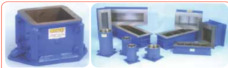
شكل (٢١) بعض أنواع قوالب فحص مقاومة الضغط للخرسانة
