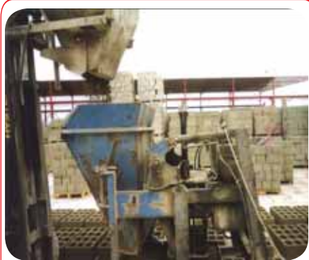
شكل (٤) رافعة شوكية تملأ المكبس الآلي
