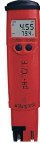
أداة لقياس حموضة مياه الري
