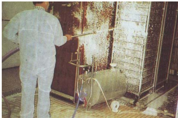
شكل (11) رش منظف ذي رغاوي لاصقة لإزالة الرواسب
